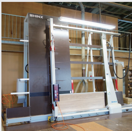
◀全自動パネルソー 「自動運転制御システム搭載型切断加工機」
