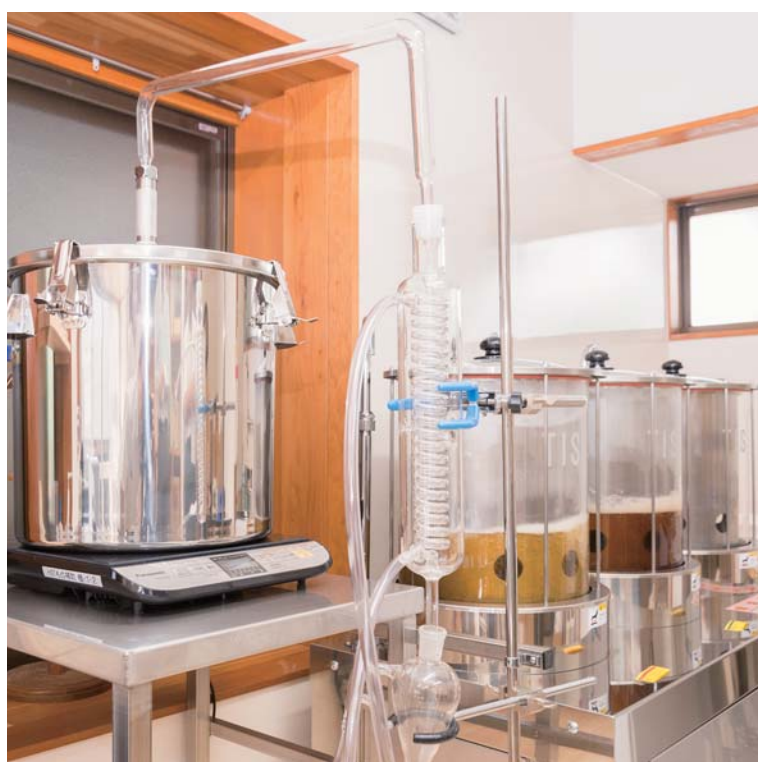
自動生薬煎じ包装機・ハーブ抽出ユニット付。
