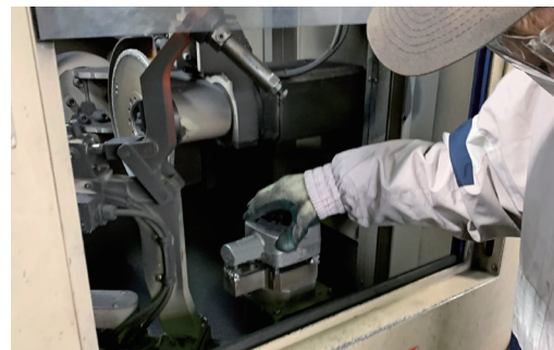
バリンダーによる仕上げ作業
