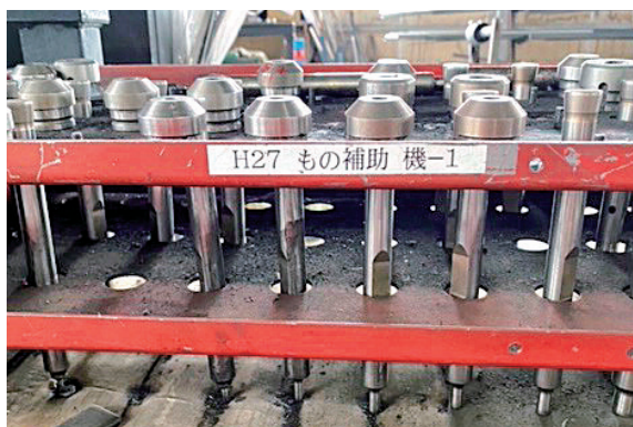
加工する穴の形状によってツールを変える
