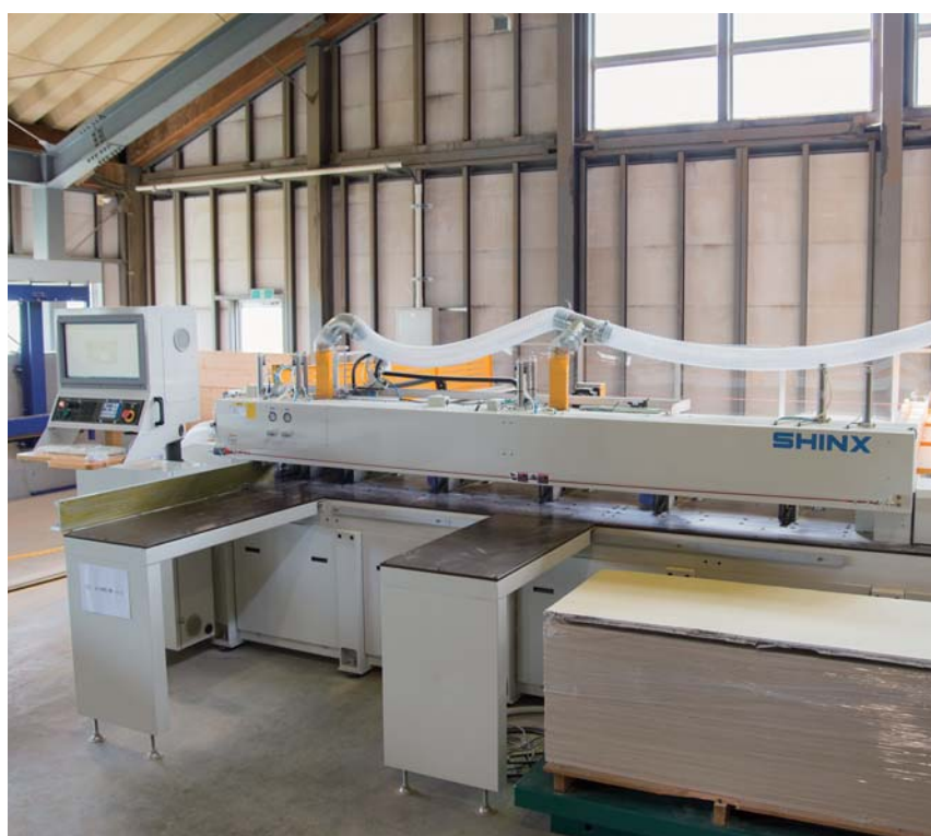
ランニングソー（石膏ボード自動切削機）を導入。
