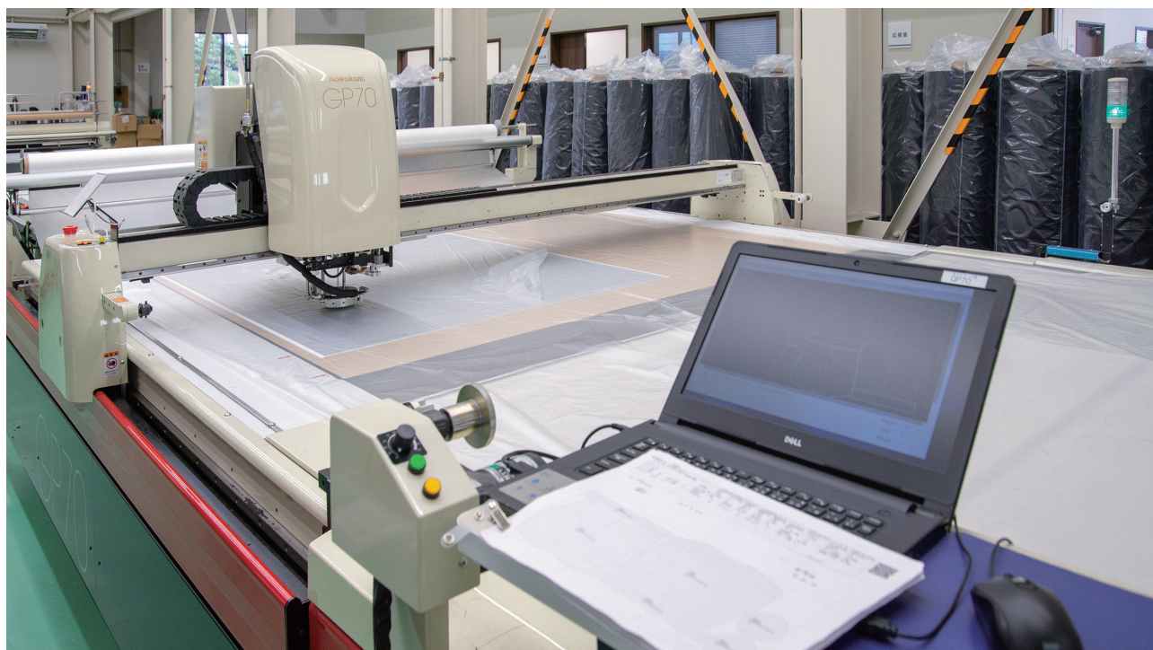
導入したパソコン搭載機の自動延反機、持ち運び可能なタブレットでの操作も可能
