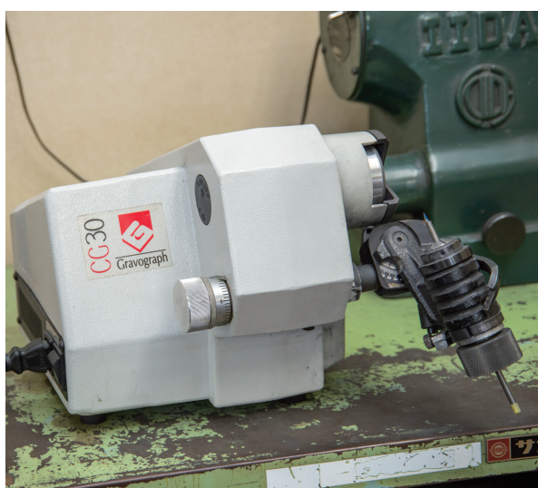
刃物の精度を高める専用グラインダー
