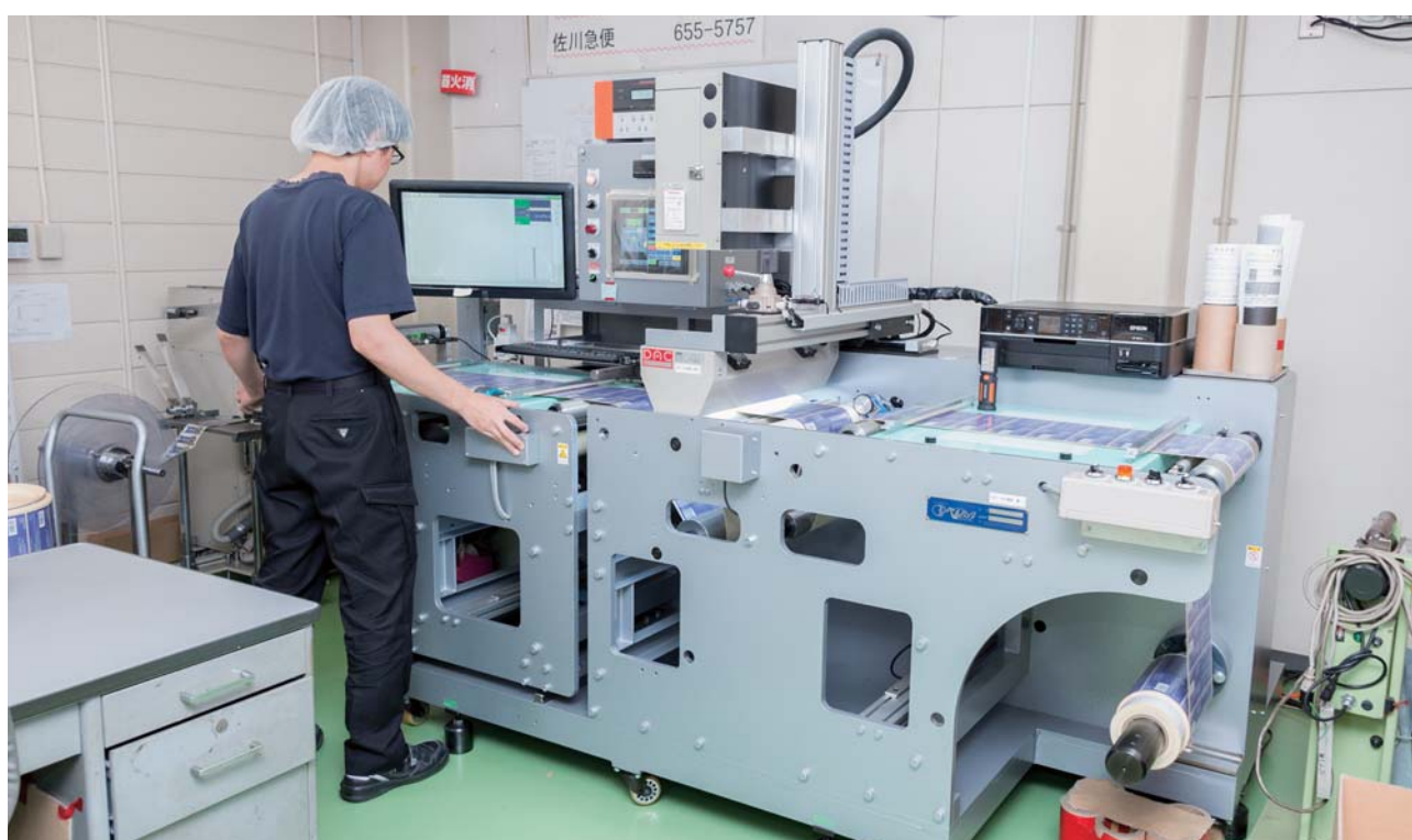
新規導入したラベル製品の検査機。
