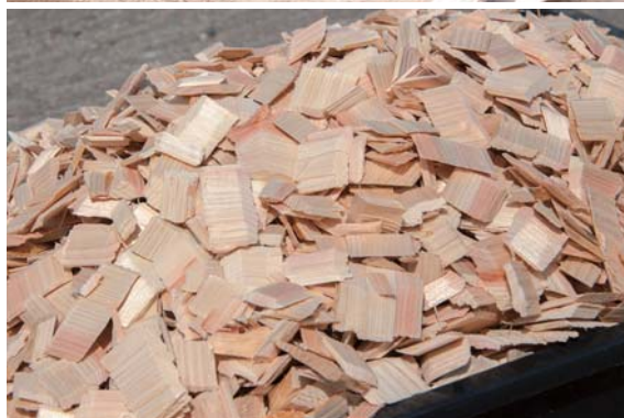
チップの大きさは2mmから15mmまで調整可能。
