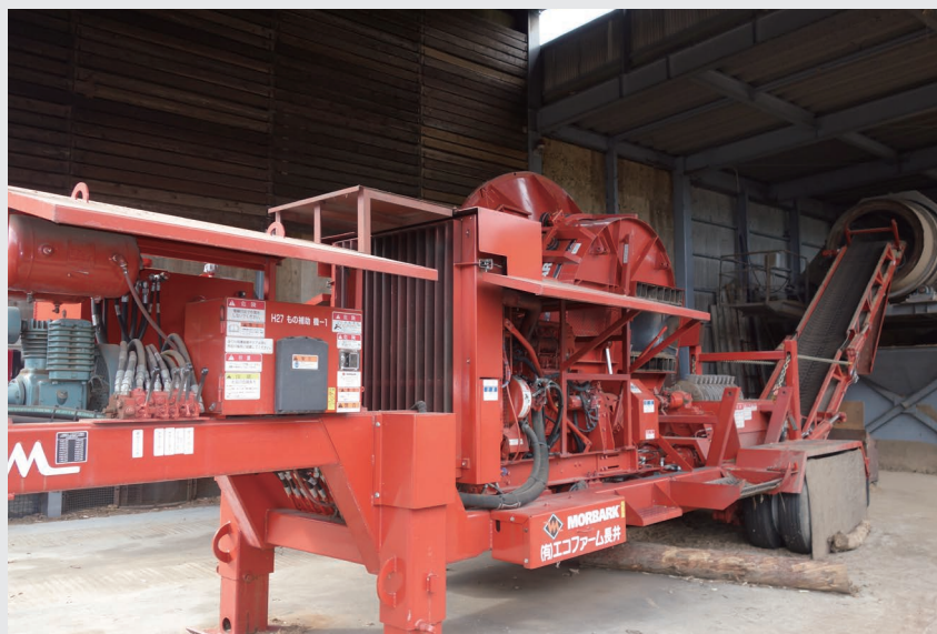
◀高出力の最新型木材破砕機。 伐根等の堅い木くずにも対応。
