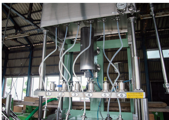
1個のノズルを合わせると6個全部が調整される
