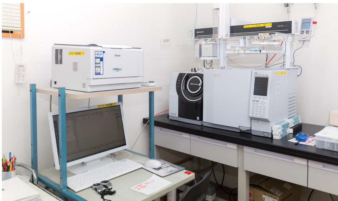
新規導入したオートサンプラー付ガスクロマトグラフィ質量分析装置 (GS-MS)。
