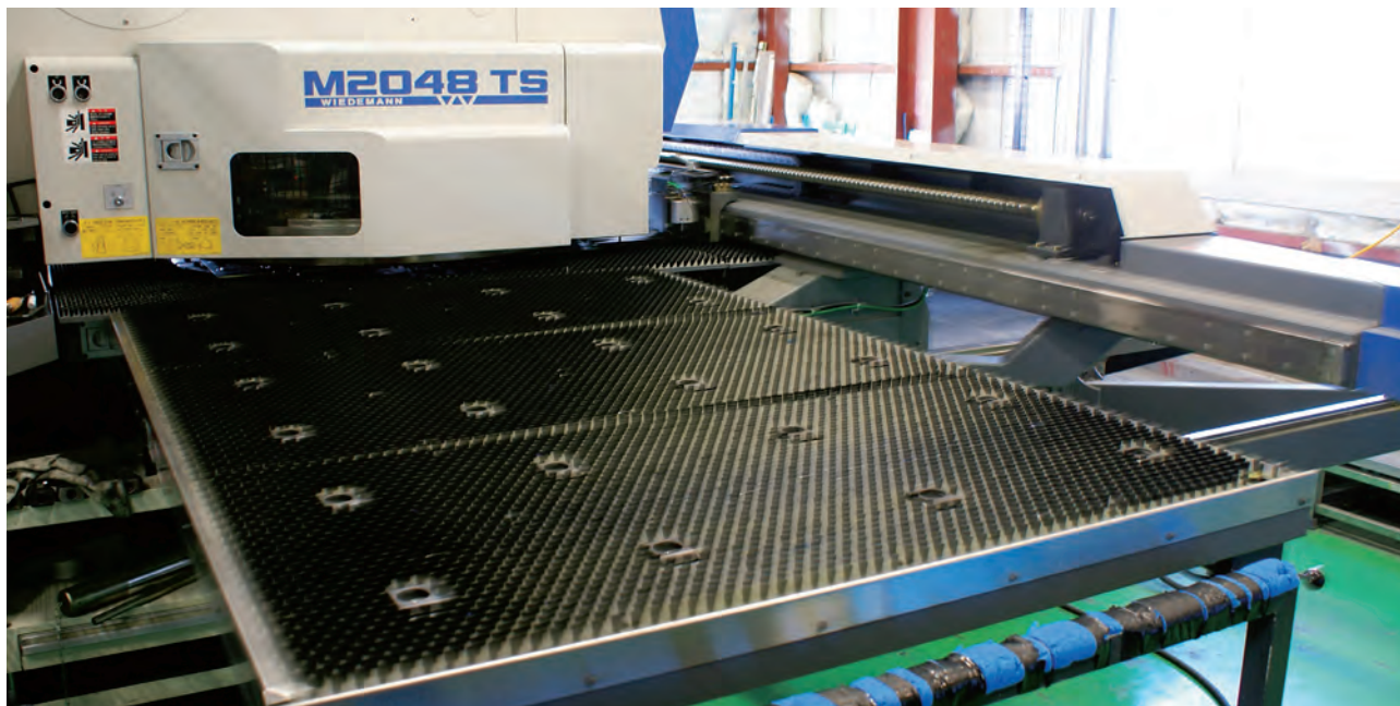
アルミ板材抜き加工に使用するタレットパンチプレス機
