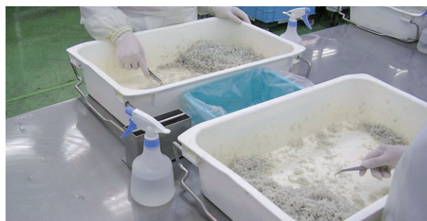
手作業での異物除去。ピンセットで手作業で行う
