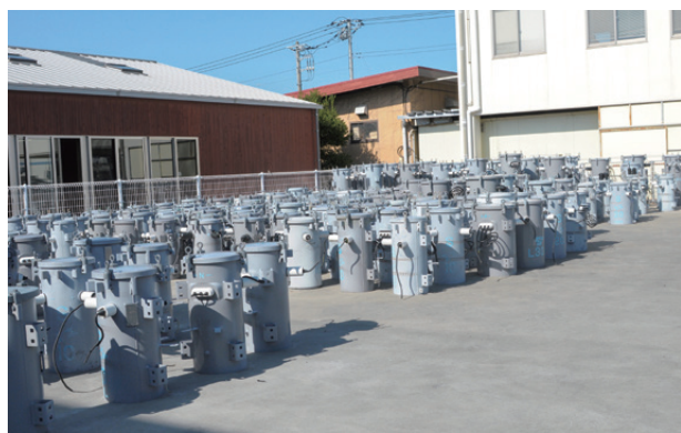
電柱の上部に設置され、配電用変電所から送られてくる6600Vの高電圧を一般家庭や事務所等で使用する100V、200Vに下げる装置
