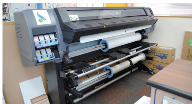
高解像度の印刷が可能なデジタルプリンター。PDFデータやスマートフォンの写真など身近な素材を利用できる
