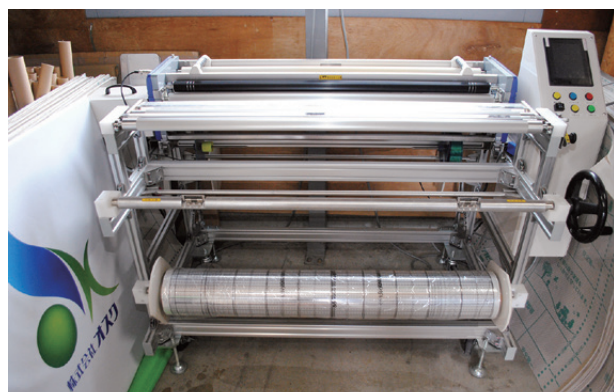
ラッピング設備があれば、現場でのりづけの必要がなく、フィルムをはがすだけで簡単に施工ができる
