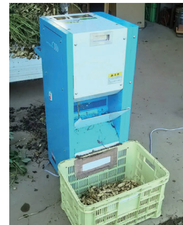
乾燥させた落花生の莢を切り離す脱英機。茹で落花生への加工用
