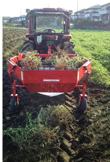
土の中から落花生を掘り上げて収穫する掘取機。大幅な効率アップにつながった
