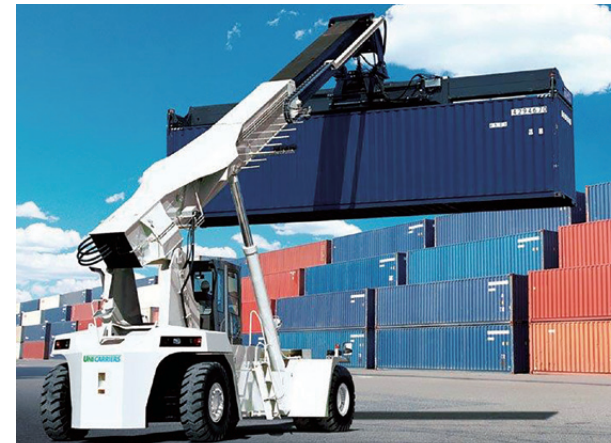
コンテナの積み降ろしや移動運搬を行う大型荷役機械「リーチスタッカー」
