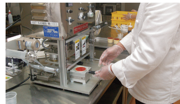
シーリングする作業は1個ずつ手作業で行う。密封できて、食べる時にはがしやすいよう強度を工夫した
