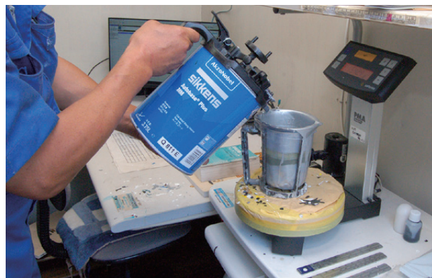
調色コンピューターで計算してはじき出された色に対し、塗料を調合。正確な計量精度を実現することにより塗料のロスが減少
