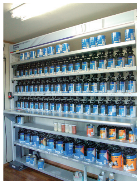
定期的に自動で塗料缶をミキシングしてくれる全自動式攪拌機。色が分離したり固まったりするのを防いでくれる
