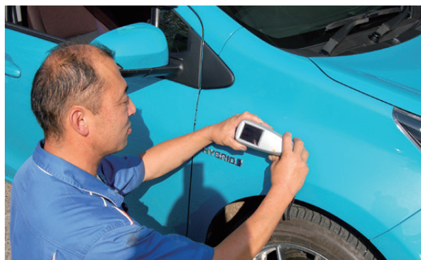
始めに、オートマチックビジョンセンサーのカメラでボディカラーを測色
