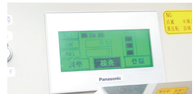
以前は目視チェックのみであったが、導入した検査機にある画面でチェックができるようになり、不良品がほぼなくなった
