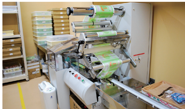
乾燥剤も同時に封入できる自動包装機の導入で、さらなるスピードアップを実現した
