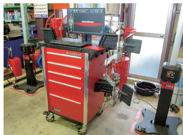
3Dアライメントテスターは、ホイールに機械を取り付けてカメラで赤外線撮影し、3D処理した画像を見てタイヤの角度や向きなどを調整していく
