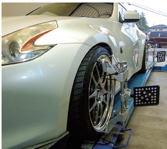
アライメントとは、タイヤ・ホイールを本来あるべき位置に戻すことで、タイヤの向きや位置、車体の傾き具合、バランスなどを含めて調整する
