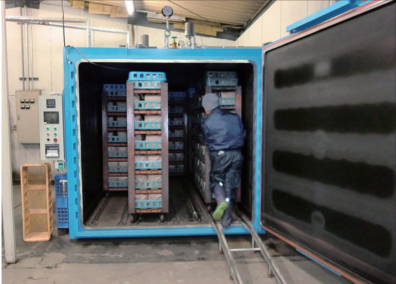
導入した高圧殺菌釜は温度管理しやすく安全性が向上
