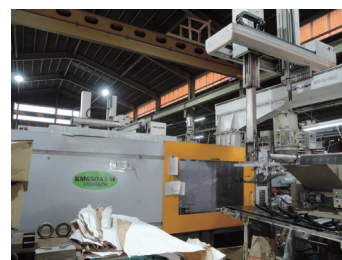
旧型の射出成形機（中央）と 成形品取出しロボット（右上）
