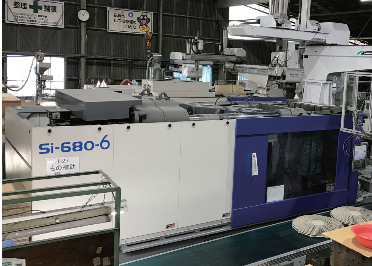
従来機より精密に制御できる電動サーボ射出成形機
