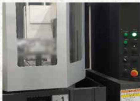
2APC部分。加工中に別の加工物を段取りし、段取り完了ボタンを押してプログラムと刃物をセットしておけば、加工が終わった時に自動で加工物を交換して加工を継続する
