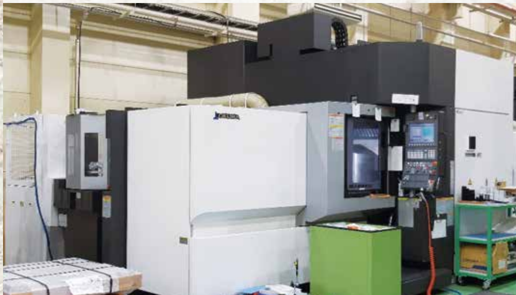
2 A P C付5軸制御マシニングセンタ MU-6300V(オークマ)
