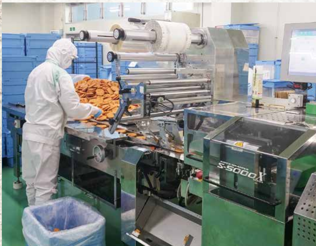
包装工程に煎餅用横ピロ包装機 S-5000X(大森機械工業)を導入
