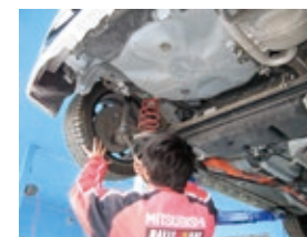
写真3.門型リフト／下回り増締め作業
