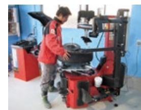
写真4.タイヤチェンジャー／タイヤ組み換え作業
