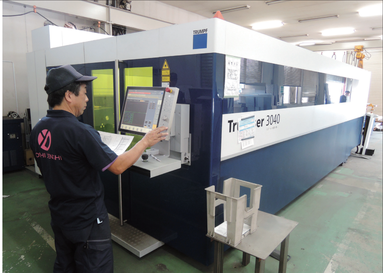
導入したレーザー加工機に自社技術を組み合わせてバリレスを実現
