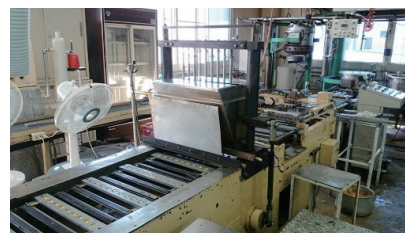
旧デポジッター成型ライン。 キャンディの冷却に扇風機を使っていた
