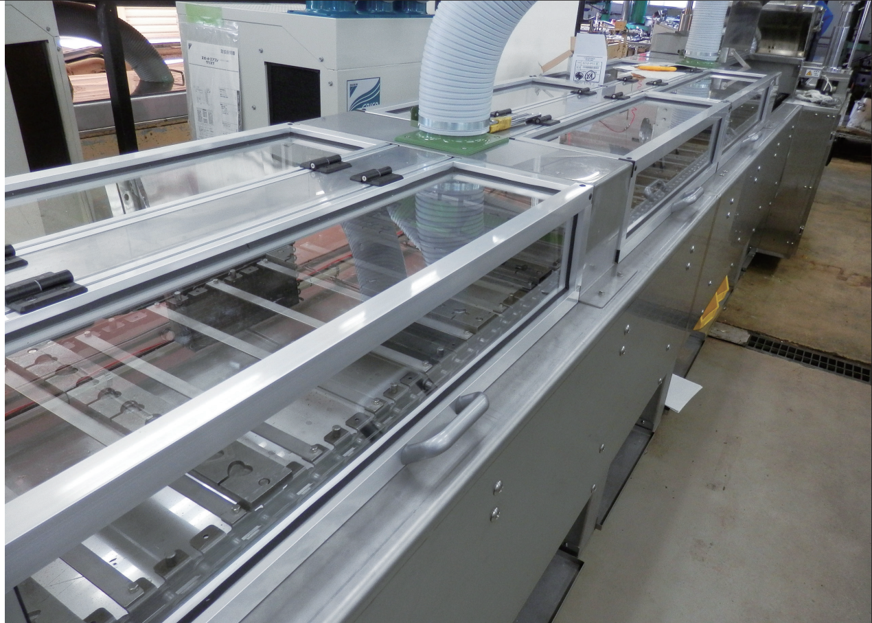
モールド（型）の取り外し可能なデポジッター成型ライン
