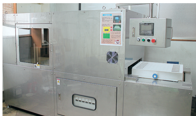
日本ハイコム製マイクロ波加熱殺菌装置：BTR-6-8 外観図
