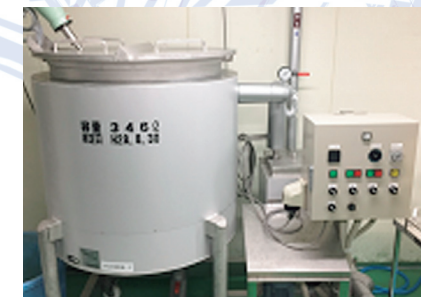
新洋技研工業製甘酒糖化タンク外観図
