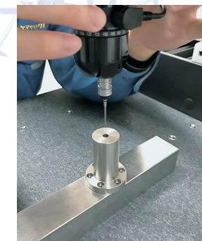
試作品を3次元測定機で測定中
