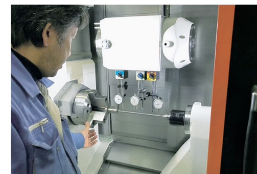
ブラシホルダーの性能評価を行っている様子
