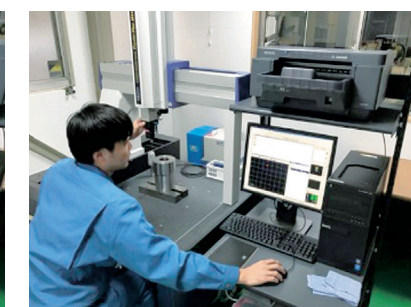
3次元測定機を用いた測定作業の様子
