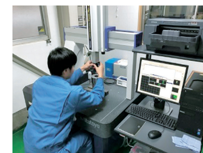
3次元測定機を用いた測定作業の様子
