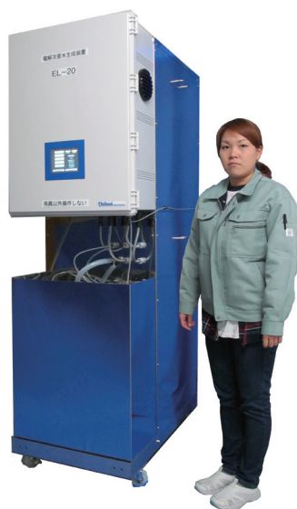
低価格で食塩電解による次亜ソ（電解水）の生成を可能にした新型装置
