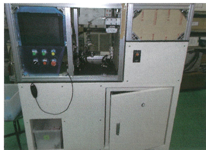
2014・2015年度設計開発装置 自動車エアバッグ用極小キャップ画像検査装置
