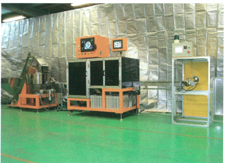
2014・2015年度設計開発装置 酒中栓画像検査装置
