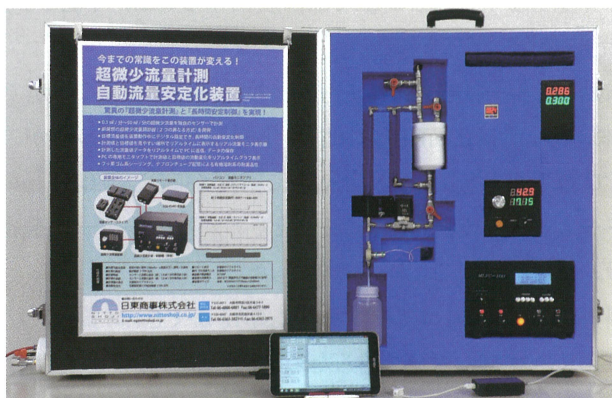
装置と溶液タンク、配管など一式を納めた機器ケース
