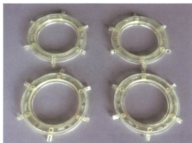
フィルターホルダー（3D プリンターにより作製）
