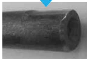
導入目的 端面面取り穴明同時加工
