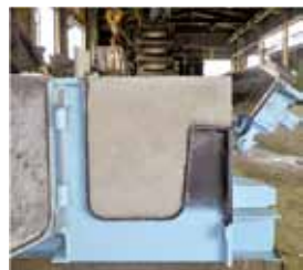
新型枠(ブロック部)
