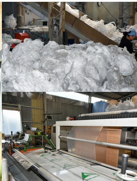
左/海外営業部の安井 瑠作さん ベトナム工場勤務を経て現在国内工場を担当する 右上/毎月80tの廃材が届き半分をビニール袋に再生する 右下/再生ビニールを圧着し袋形状に加工する
