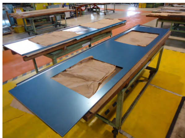
最新モデル4mベンダー機により折り曲げ加工した製品
