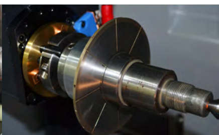
側面への溝加工
