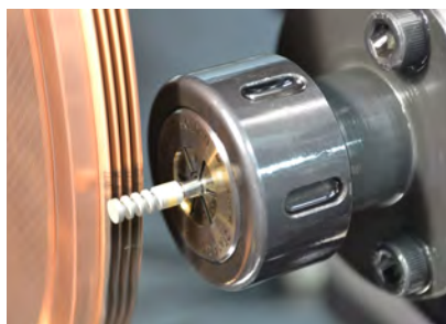
微小径砥石への溝加工
