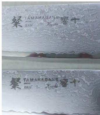
上：レーザーマーカによるマーク 下：電気腐食での不良
