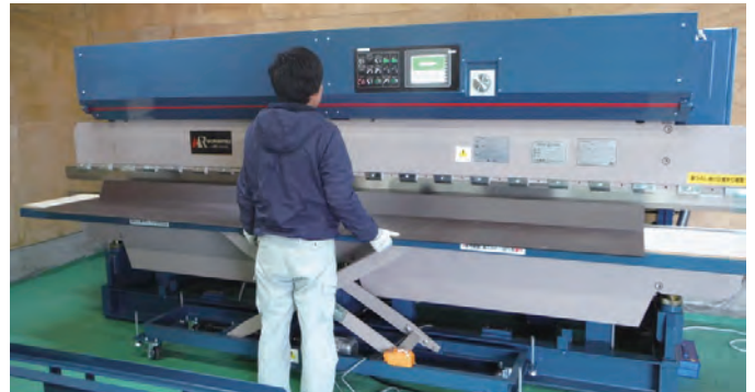
本事業で導入した住宅板金屋根用折曲機
