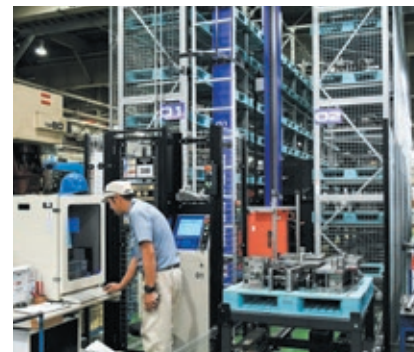
約800個の金型を収納、出し入れする大型の自動倉庫
