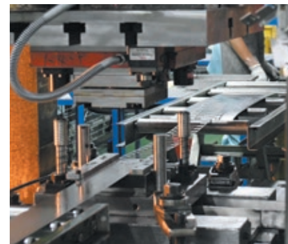
金型交換支援システム「油圧クランプ」
