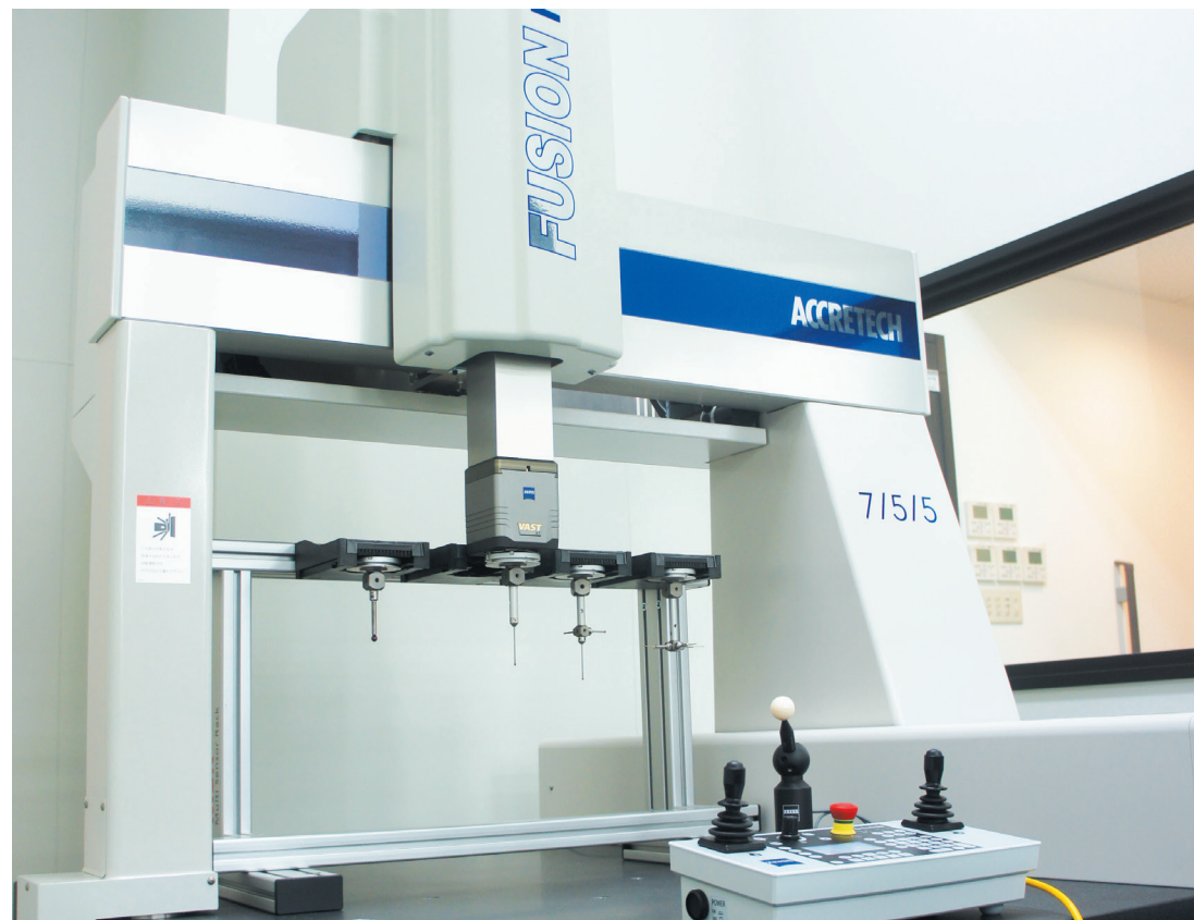
平成27年の補助金で導入した3次元測定機
