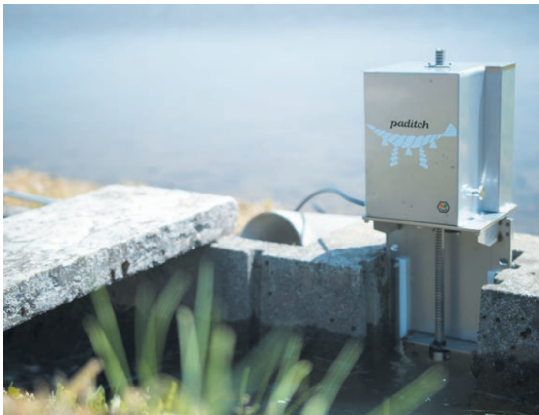
水田に設置されたIoT水門「paditch gate 01」
