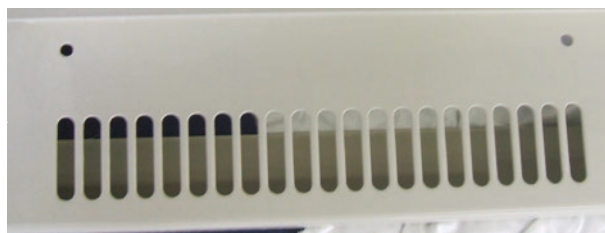
事業後塩水噴霧1,000時間試験結果、発錆は見られない
