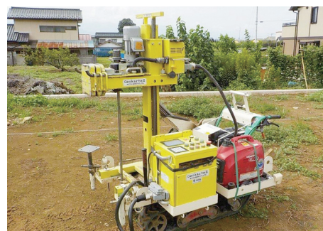
◀ 導入した最新型SWS地盤調査機
