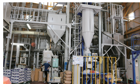
新たに導入した乾式無洗米機と酒米精米機を取り入れた米粉生産ライン
