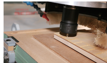
▲NC旋盤の刃の部分。作業内容に応じてさまざまな専用刃を使い分ける
